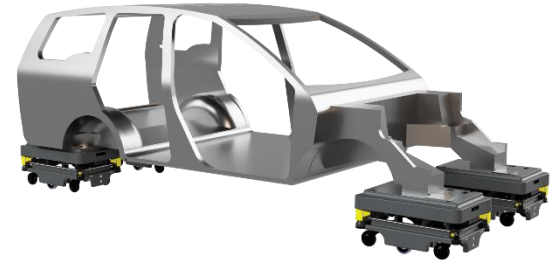
Kooperativer Objekttransport einer Autokarosserie
