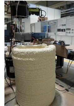
Simulation additive Fertigungsverfahren mittels PU-Schaum
